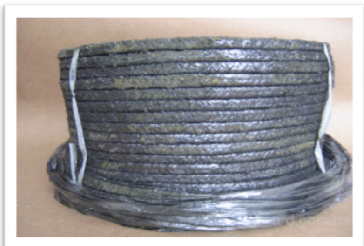
Guarnizioni contenenti amianto.
