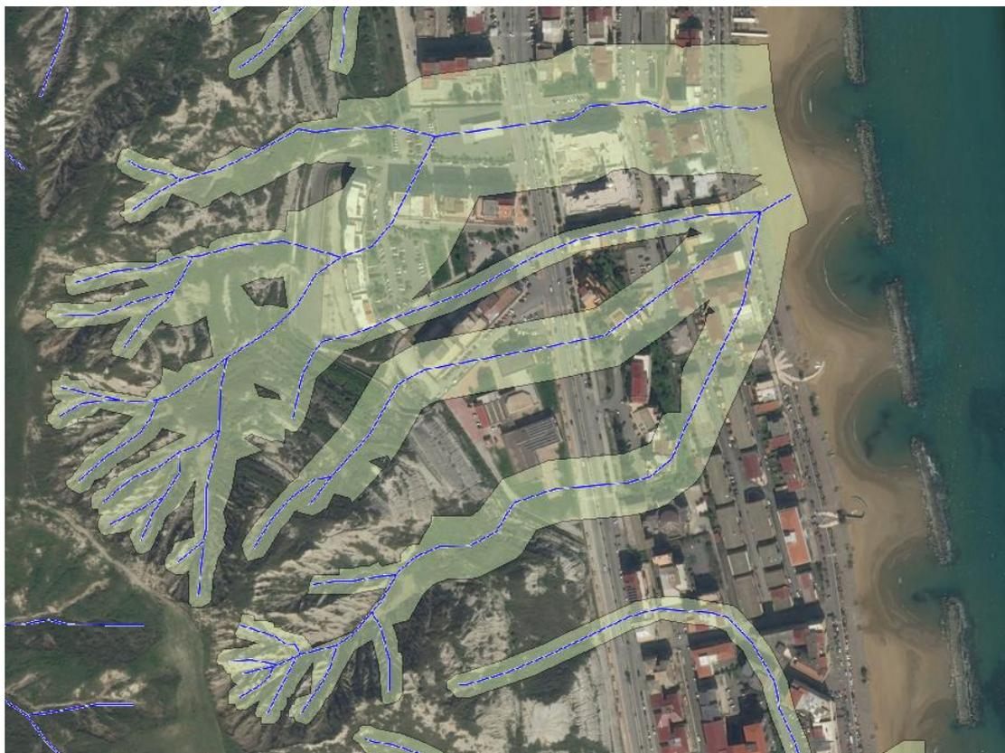
Figura 3 – Reticolo PAI e relativo areale di pericolosità P3 di livello intermedio (Via Calipari).
